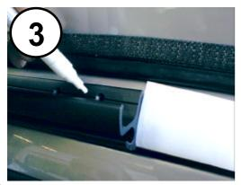
Die Universalschiene mit Vorderkante bündig an der Markierung und parallel zur Fahrzeugkontur anhalten. Beide vorderen Bohrungen markieren. Körnen. Bohren mit Bohrer 3,2 mm.
