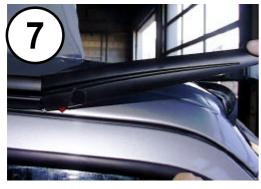
Überschüssiges Sika vorsichtig mit Reiniger entfernen. Zur Verklebung der Endstücke etwas Sika auf die Schienenenden und den ersten cm des Enstücks auftragen. Die Schutzfolie der Endstücke mit etwas Tesafilm verlängern, so daß sie flach abgezogen werden können. Die Endstücke schräg ansetzen. Die vordere Schutzfolie cm für cm entfernen und Teil anpressen. Belastung erst nach 24 Stunden Aushärtung.
