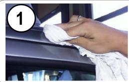
Blech oberhalb der Türen gründlich mit Aceton reinigen und entfetten! Spalt unterhalb des Radius mit Klebeband abkleben.
